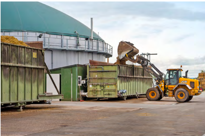
Beim Befüllen der beiden Feststoffdosierer werden die Mengen aller Substratkomponenten exakt und in Echtzeit dokumentiert.
