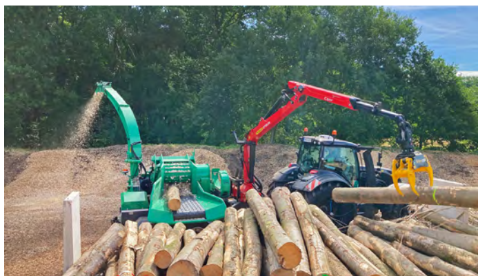
Mit selbstbeschickten Trommelhackern können Hackschnittel von gleichbleibender Qualität erzeugt werden. Fotos: Gerold Tammen
