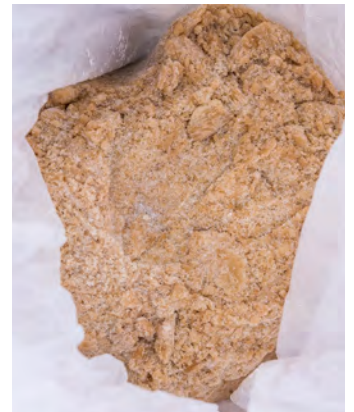
Die Zugabe der kultivierten und schockgefrorenen Turbobakterien (Methanos) erfolgt einmal in der Woche über den Feststoffdosierer.
