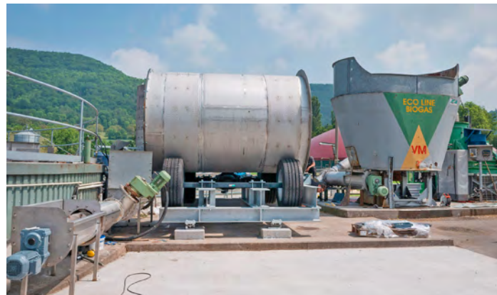
Die für den Versuch aufgebaute Kugelmühle Fotos (3): Uni Hohenheim
