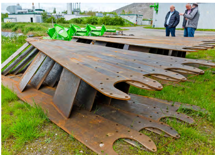
Die Teile für die geplante Nachrüstung des Fermenters 1 mit drei Paddelrührwerken liegen schon bereit.
