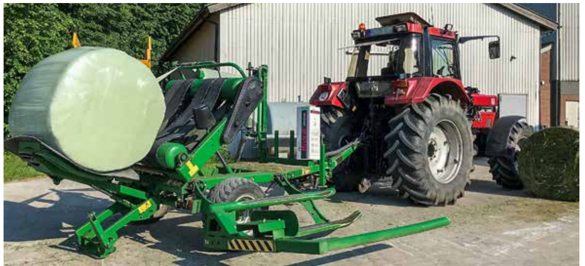
Für die Silierung der Luzerne fiel die Wahl in Futterkamp auf Rundballen. Um eine Perforation der Folie durch die harten Stoppeln zu vermeiden, wurden Pressen und Wickeln ab der zweiten Ernte nicht mehr kombiniert. Direkt nach dem Pressen erfolgte der Transport auf den Hof, wo ein separater Wickler das Einstretchen der Ballen übernahm.
