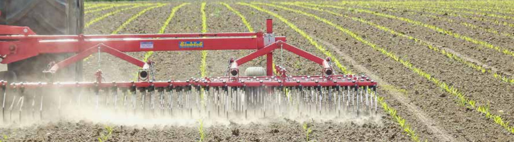
Der Striegel ist ein wichtiges Gerät für die Beikrautregulierung im Ökomaisanbau.
