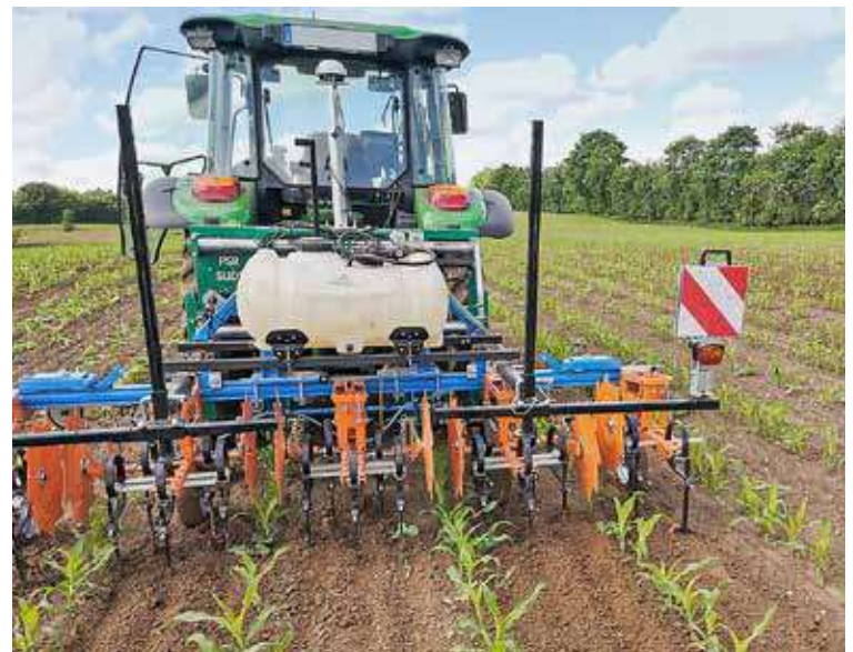
Eine Reduktion des Einsatzes chemischer Pflanzenschutzmittel kann über die Reduktion der behandelten Fläche erfolgen wie bei der Unkrautbekämpfung in Reihenkulturen durch die Kombination von Bandspritze (Behandlung in der Reihe) und Hacke (Unkrautbekämpfung zwischen den Reihen). Foto: Nils Bols
