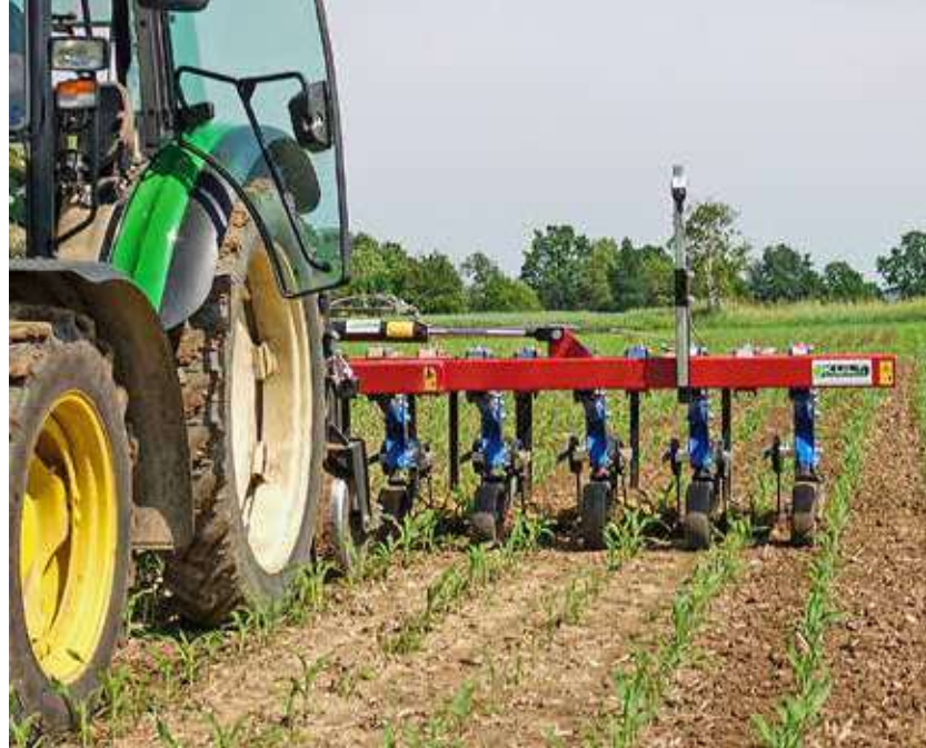
Einsatz einer modernen, kamerageführten Scharhacke im Ökomais
